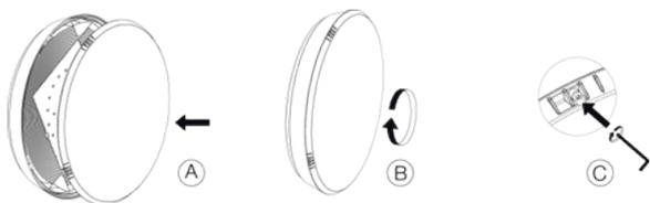
Fig. C (version anti-vandale) : Visser la vis anti-vandale prémontée à l'aide de l'outil référence **98110010**.
